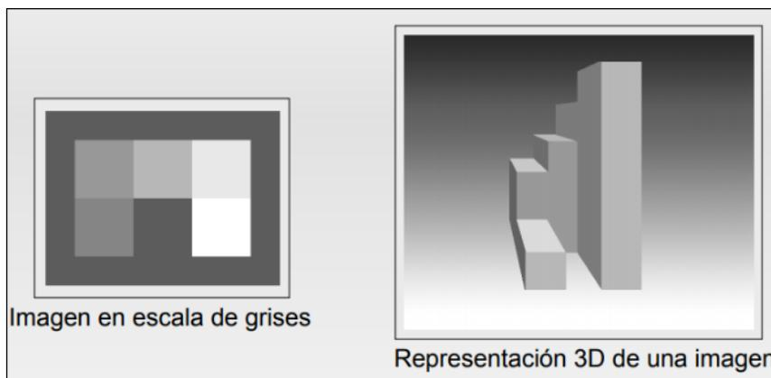
**Figura 3.** Imagen en escala de grises con su correspondiente representación en un plano 3D.
