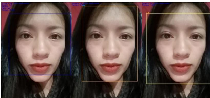
**Figura 24.** Imágenes normalizadas aplicando escalado en dimensión para los modelos Viola & Jones, MTCNN y YOLO de izquierda a derecha
