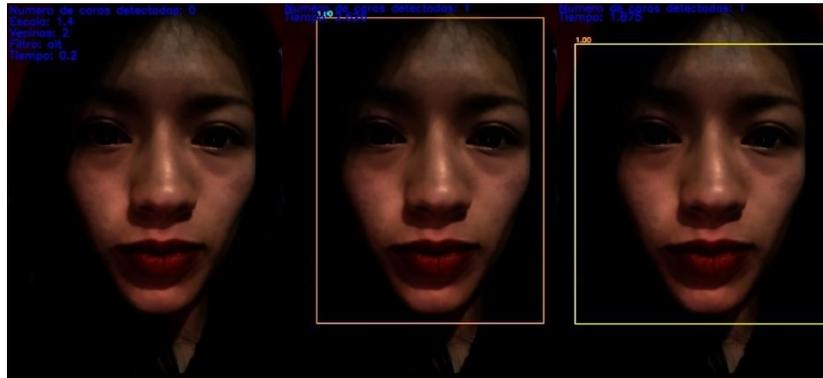
**Figura 60.** Imágenes normalizadas con un factor de corrección gamma de 0.25 para los modelos Viola & Jones, MTCNN y YOLO de izquierda a derecha
