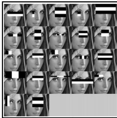
Figura 3. Convolución del filtro Haar-like con una imagen integral Fuente: (Caballero Barriga, 2017)
