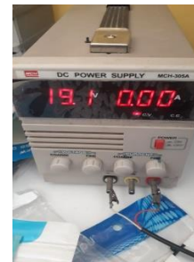
Fuentes de poder regulares de voltaje y amperajes con protección a cortos circuitos
