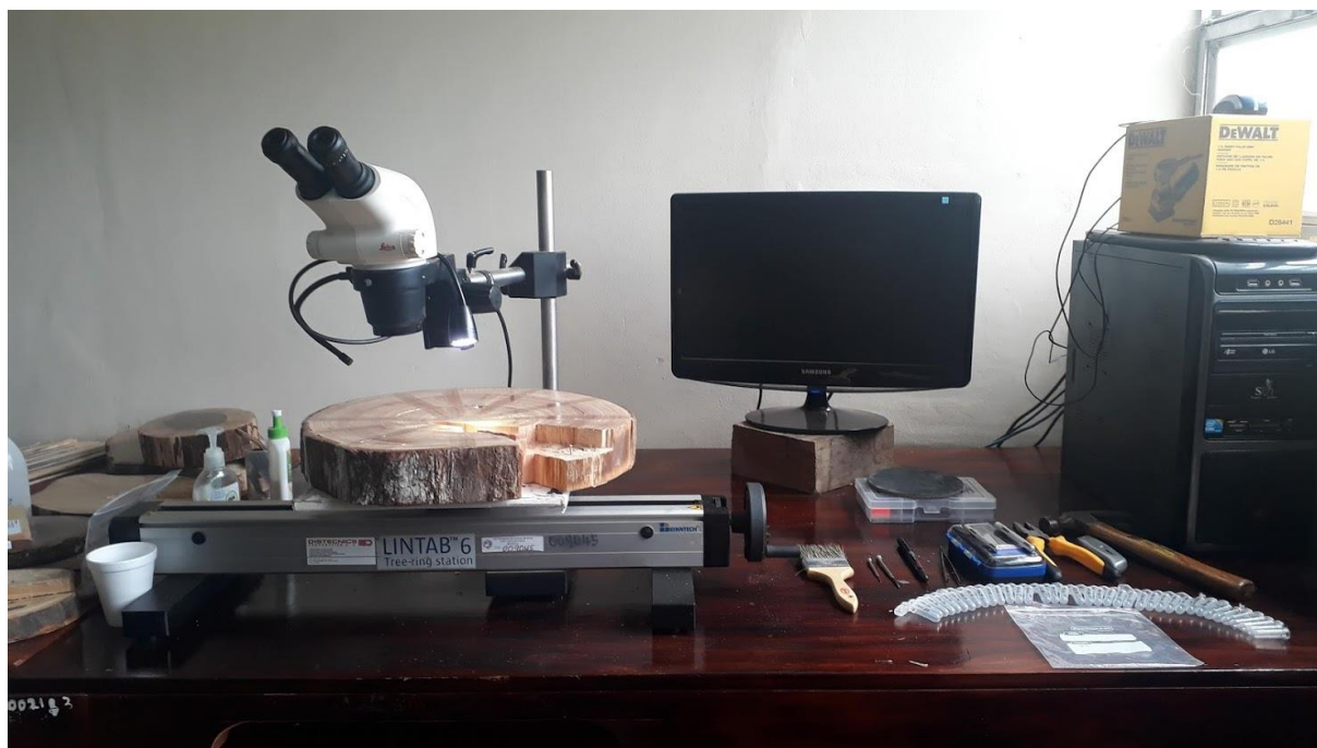
Figura 16. Sistema Lintab6 Pro para la medición de anillos de crecimiento en Cedrela sp.
