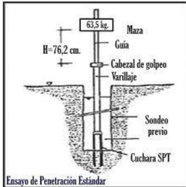
Figura 2. Ensayo de penetración estándar (SPT)
