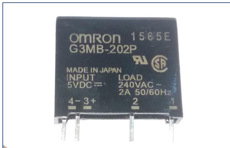
Figura 20. Relé de estado sólido empleado. Fuente: El autor
