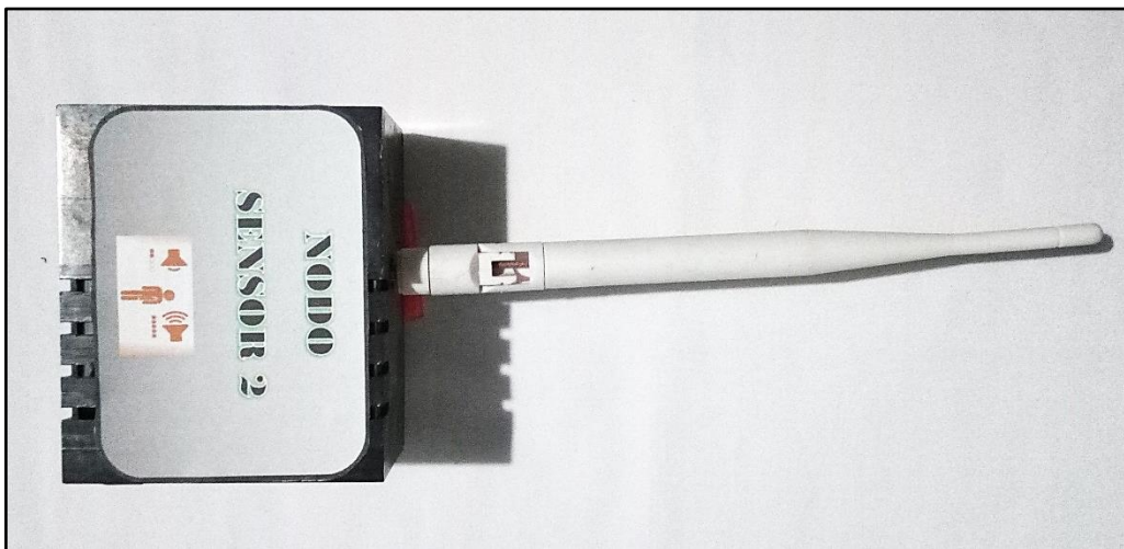
Ilustración 105: Montaje del nodo sensor 2 para el monitoreo de Ruido Fuente: Autor
