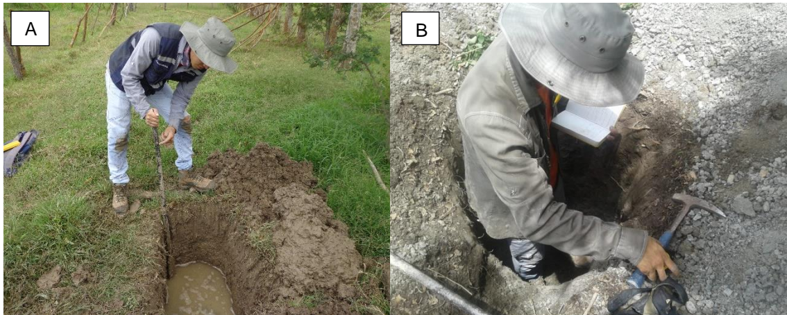
Fotografía 4. A) Apertura de calicatas por medios manuales B) Toma de datos y determinación de propiedades físicas in situ
