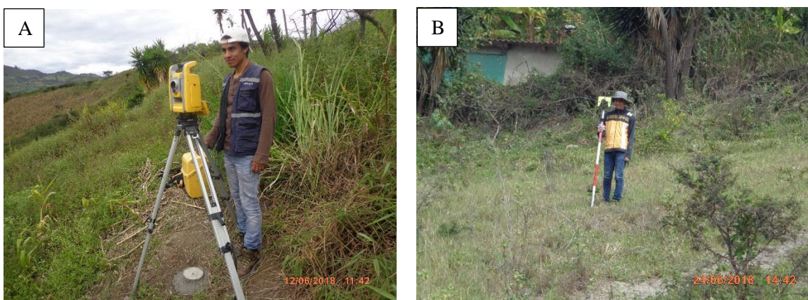
Fotografía 1. Levantamiento topográfico A) Punto de control; B) Levantamiento con prisma
