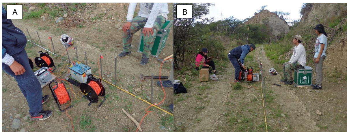
Fotografía 3. A) Equipo SYSCAL R1 PLUS - Arreglo Schlumberger B) Lectura de datos y disposición de electrodos
