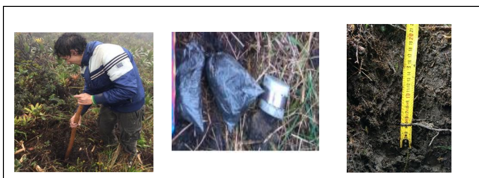
Figura 8. Calicatas para la obtención de las muestras de suelo y profundidad del horizonte orgánico
