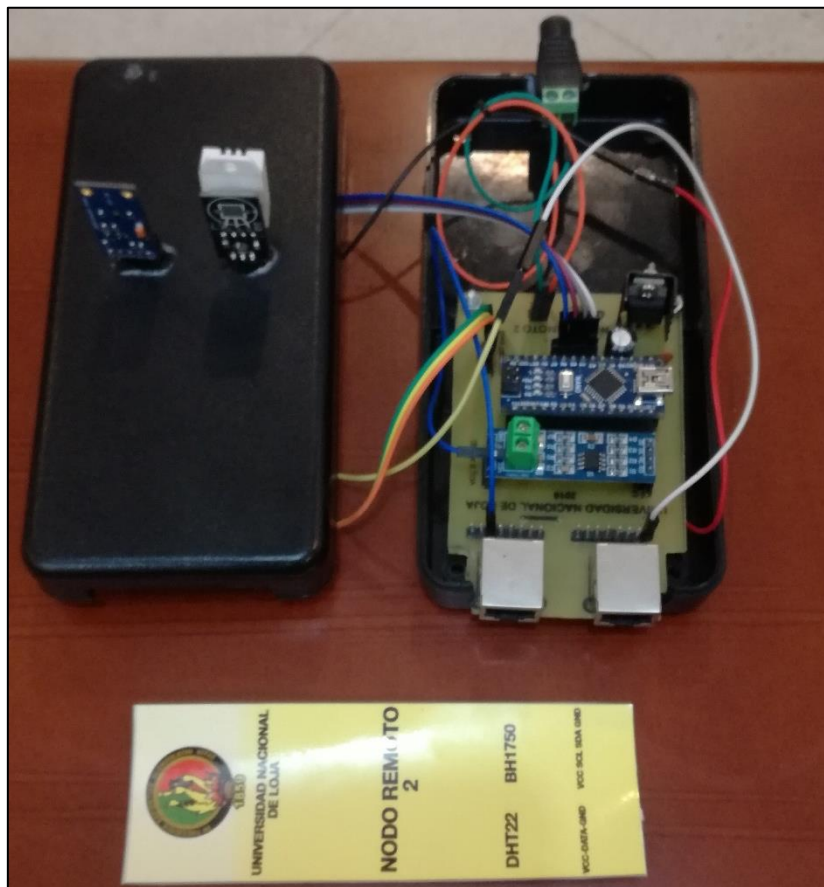
Figura 39. Componentes de Nodo Remoto. Fuente [El Autor]
