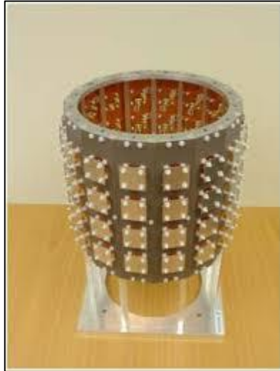
Figura 6. Arreglo cilíndrico de antenas en MIMO Masivo, [14].
