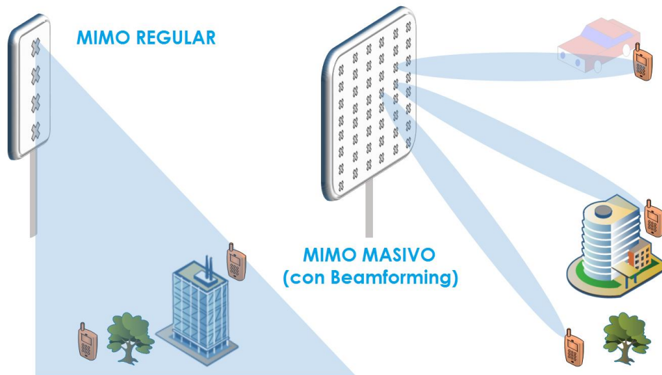
Figura 9. Funcionamiento de MIMO y MIMO Masivo con Beamforming.
