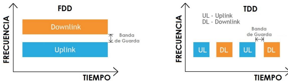
Figura 14. Comparación entre FDD y TDD.
