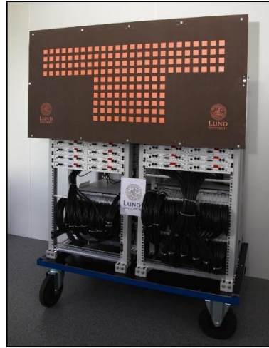
Figura 7. Arreglo rectangular de antenas en MIMO Masivo, [14].
