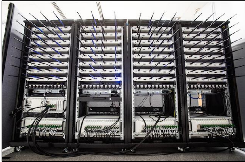
Figura 5. Arreglo de antenas en MIMO Masivo, [14].
