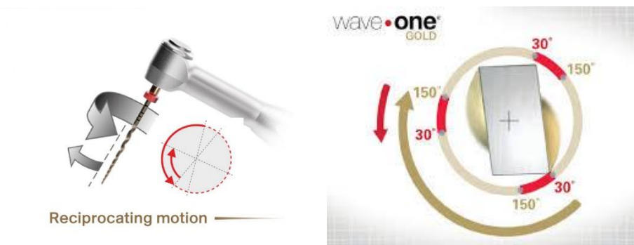
Figura 24. Ángulos de Reciprocación del sistema Wave One Y Wave One Gold Autor: Webber Julián
