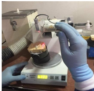
Figura 32. Corte longitudinal de la raíz mesial mediante Sierra para modelos DIACUT Vario con disco tronzador de diamante Autor: Tatiana Cuestas Fuente: ViTi Laboratorio Dental
