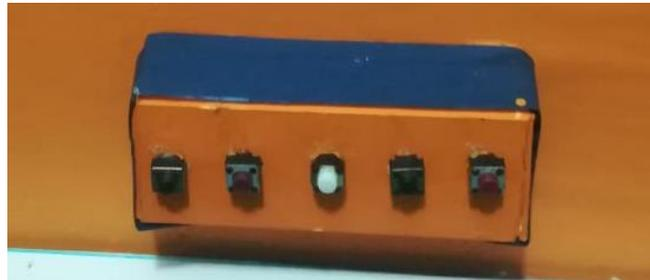
Figura 35. Pulsadores de la pantalla en el prototipo
