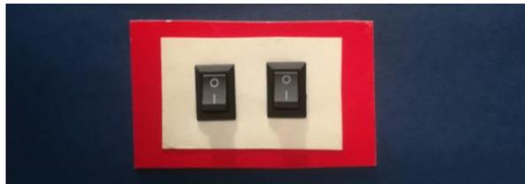
Figura 29. Interruptores ventiladores en el prototipo
