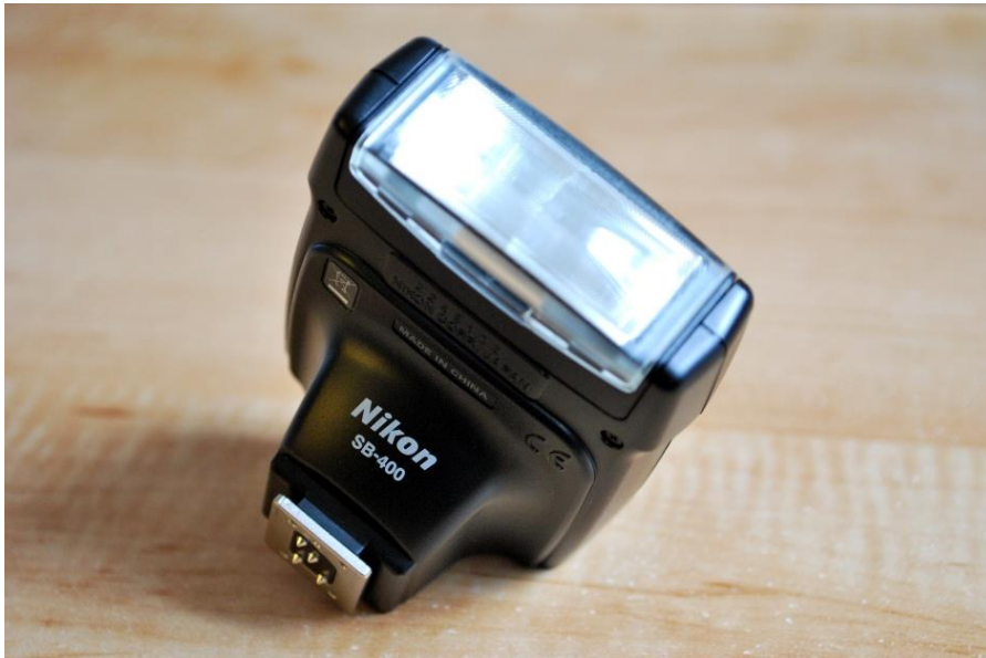
Figura 9. Flash externo que generalmente va enganchado en la parte superior de la cámara
