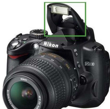
Figura 8. Flash Integrado, vienen integrados en las cámaras compactas y réflex.
