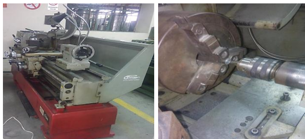
Fig. 14. Torno manual con visualizador digital modelo T-1840 marca Travis Fuente: Jackeline Cecibel Guamán Camacho
