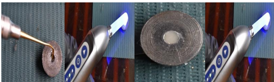
Fig. 17. Elaboración de especímenes de Resina Filtek™ P60 3M Fuente: Jackeline Cecibel Guamán Camacho
