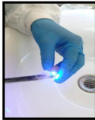
**Fotografía 10:** colocación de adhesivo. **Fotografía 11:** Fotocurado de las piezas por 20 s
