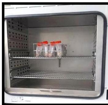
**Fotografía 30:** Termociclado manual BINDER **Fotografía 31:** Muestras colocadas en el termociclado
