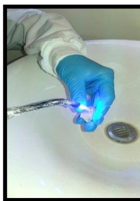
**Fotografía 12:** Colocación de la resina fluida compuesta **Fotografía 13:** Fotocurado de las piezas con resina
