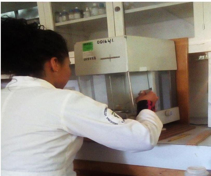
**Figura 4:** Pesaje de los crisoles en la balanza analítica
