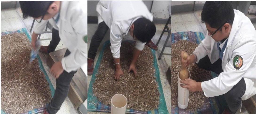
Figura 4. Llenado y compactación de los microsilos
