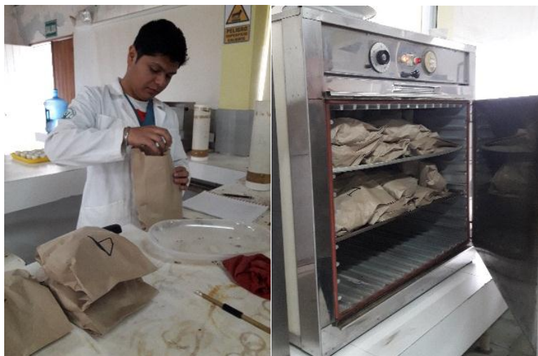
Figura 7. Determinación de humedad parcial
