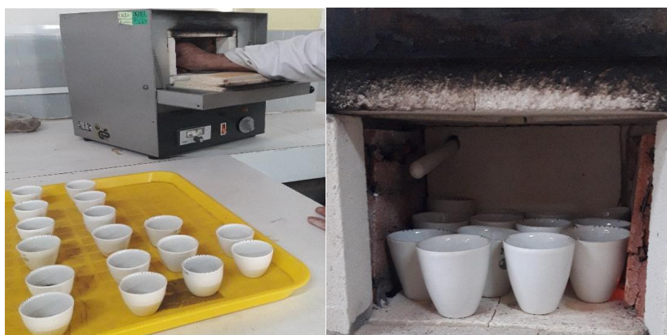
Figura 9. Determinación de cenizas
