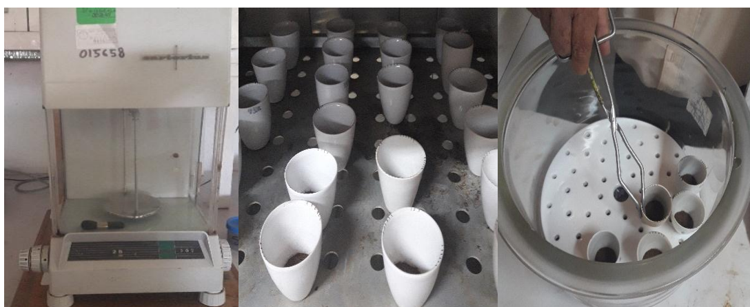
Figura 8. Determinación de humedad higroscópica
