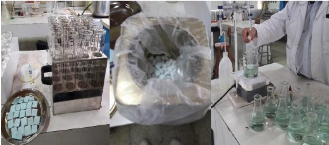
Figura 10. Determinación de proteína cruda
