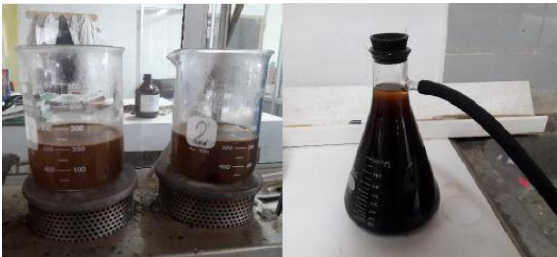
Figura 11. Determinación de fibra cruda
