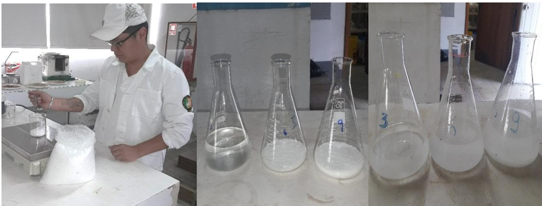
Figura 2. Pesaje y dilución de la urea para el proceso de amonificación
