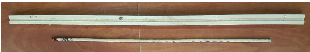
Figura 17 Desmontado de la muestra para colocar pegamento en el soporte, sin cambiar la dirección original en la que fue tomada la muestra.
