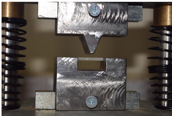
Figura XII: Test de resistencia a la flexión. Fuente: José Luis Sarango Guailas.
