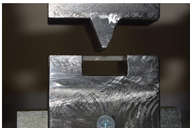
Figura XII: Prueba de resistencia a la flexión. Fuente: José Luis Sarango Guaiillas.
