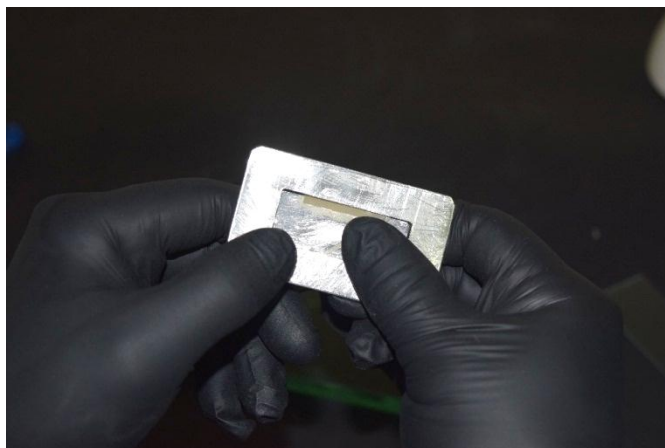
Figura IX: Desmoldado del bloque de resina. Fuente: José Luis Sarango Guailas.
