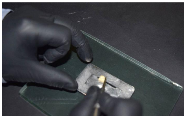
Figura V: Colocación de la resina. Fuente: José Luis Sarango Guailas.
