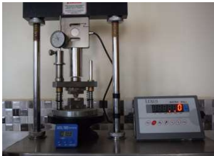
Imagen 5: Máquina Ensayo Universal Marshall PS25 Autor: Pablo Loyola
