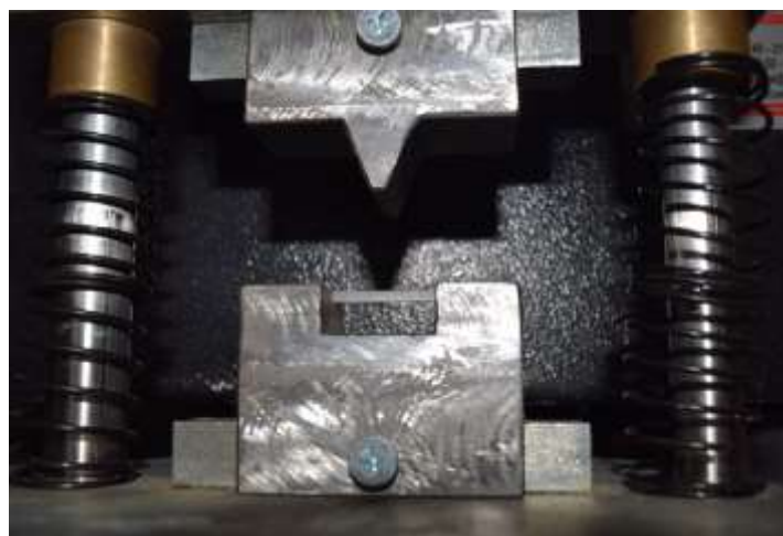
Imagen 6: Bloque montado en la máquina de ensayos universal Autor: Pablo Loyola
