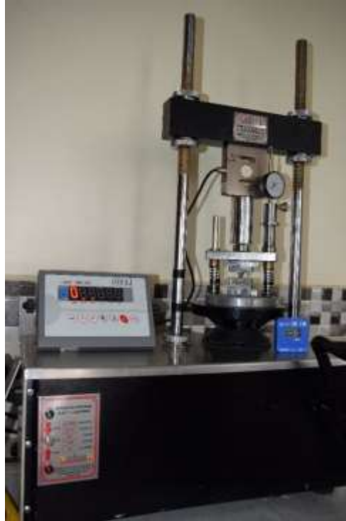
Foto 15: Maquina Ensayo Universal Marshall PS25 Autor: Pablo Loyola
