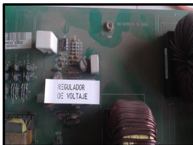
Figura 25: Regulador de voltaje
