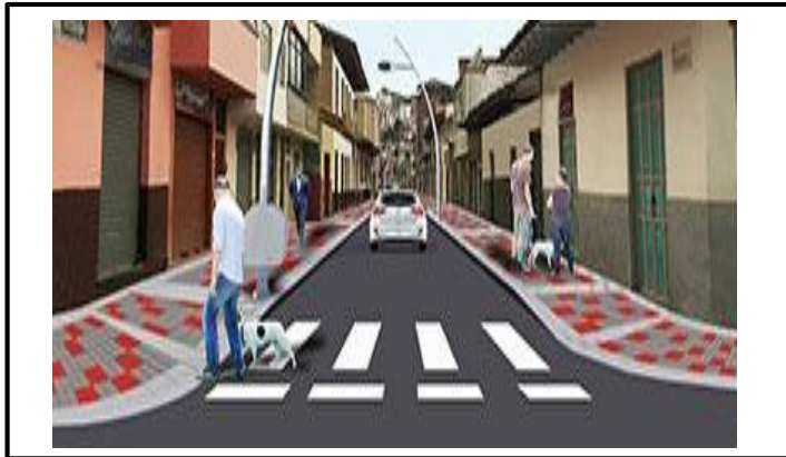
Figura 44. Modelo: rampas esquinas de las aceras.
