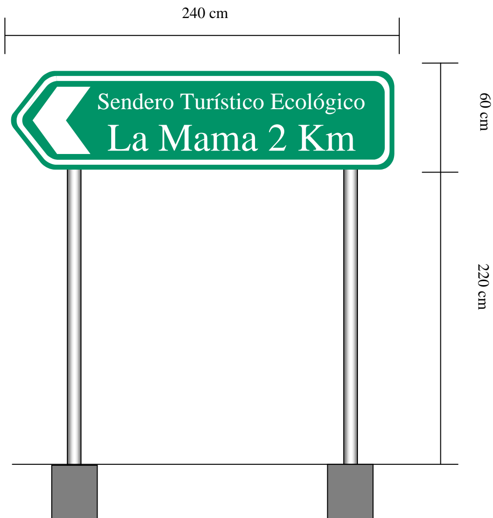
Figura 5. Señal de aproximación
