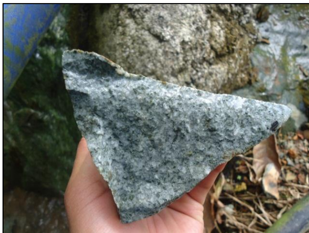
Fotografía 11. Muestra de cuarzoandesita porfídica de hornblenda del afloramiento AMV001.
