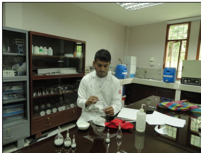
Fotografía 4. Llenado de los picnómetros con el material pulverizado.
