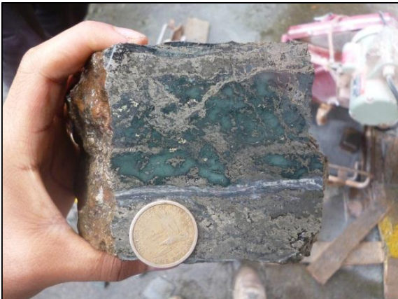
Fotografía 9. Corte de una muestra de la veta Milagro. Nótese el escaso contenido de cuarzo.
