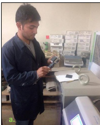
a. Toma de datos de las probetas cúbicas de roca e ingreso de los mismos en la máquina.
