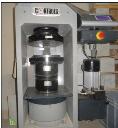
b. Ejecución de ensayo de resistencia a la compresión simple de los especímenes de roca.
