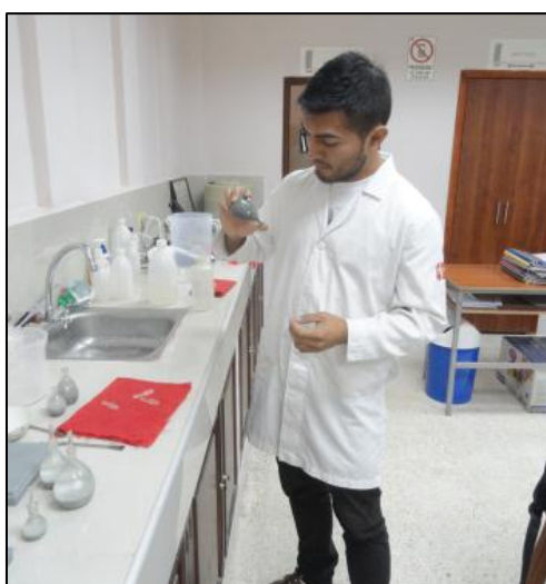
Fotografía 5. Agitación de la muestra pulverizada y agua destilada contenidas en el picnómetro.
