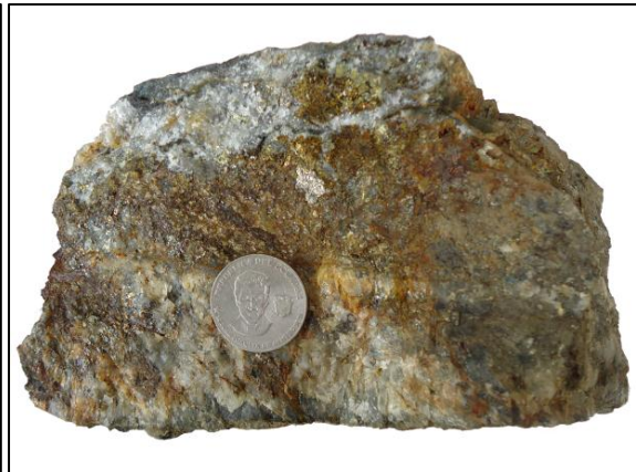
Fotografía 10. Muestra de la veta Lupe. Puede apreciarse la presencia de cuarzo y sulfuros.
