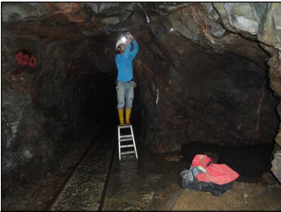
Fotografía 3. Toma de datos estructurales en el techo de la galería principal de transporte.
