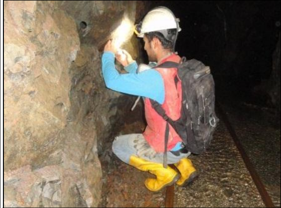
Fotografía 2. Medición de datos estructurales en diaclasa de pared izquierda de la galería principal de transporte.
