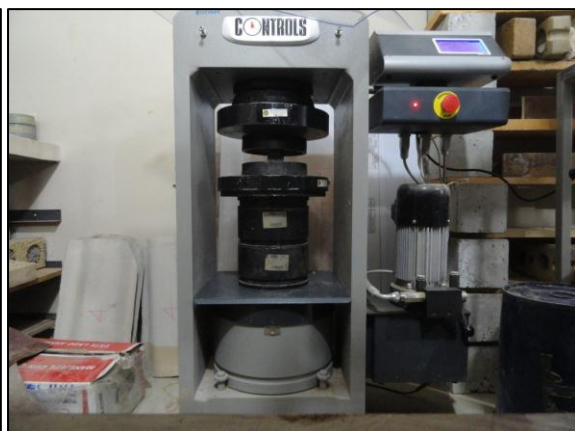
Fotografía 12. Prensa empleada para la determinación de la Resistencia a la compresión simple de la matriz rocosa.
