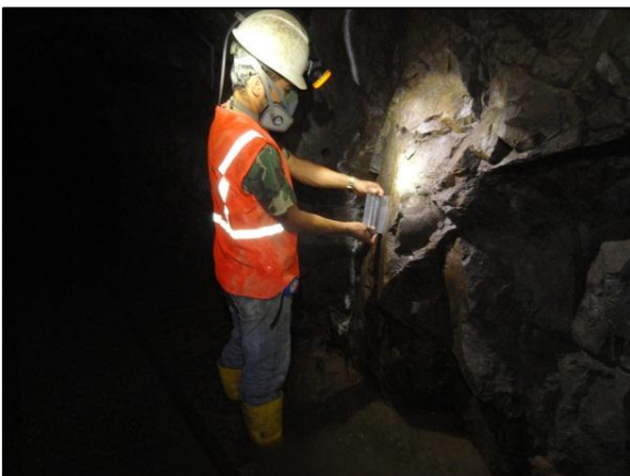
Fotografía 5. Medición de la rugosidad mediante el empleo del Peine de Barton.
