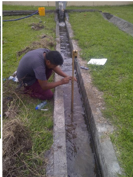
c. Aforo del caudal por el método gravimétrico y Toma de datos de velocidad con el dispositivo en los respectivos canales.
