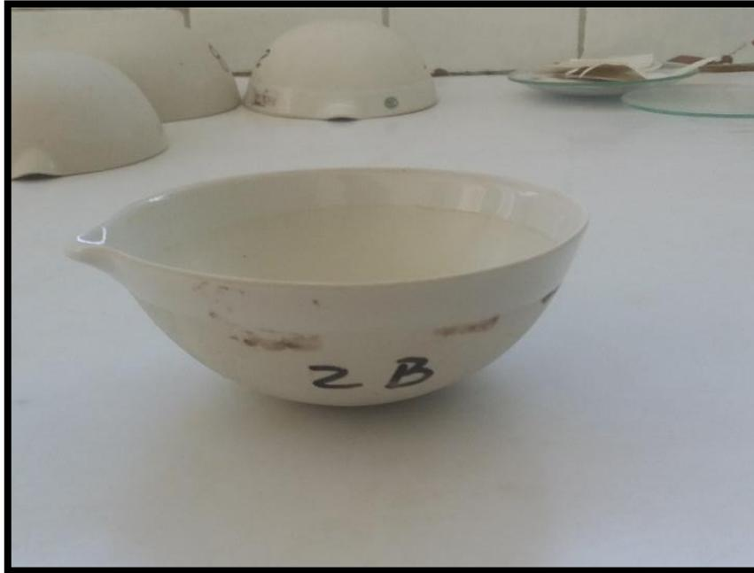
**Figura. 6.** Cápsula para determinar sólidos
