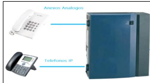
Fig. 2. Extensiones de una Central Telefónica. [17]
