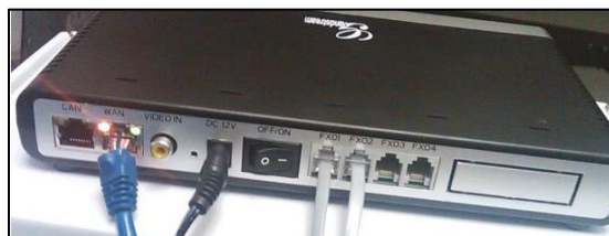
Fig. 46. Central de la facultad de Energía Granstream GXW410X. [Elaboración propia]
