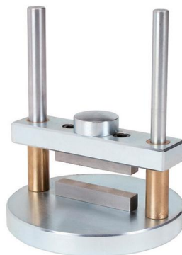
Figura 81. Cabezal de rotura Lottman.
