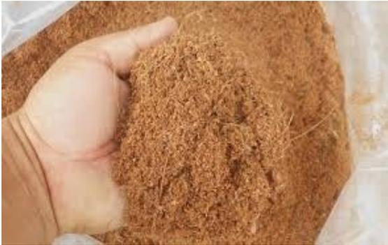
**Figura 13.** Aserrín para la producción del ladrillo.
