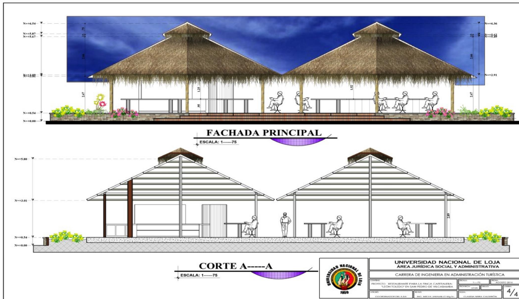
Figura N° 25: Propuesta de Diseño: Restaurante, Fachada – Corte, para la Finca “León Toledo”
