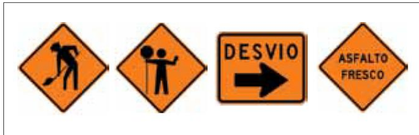
Figura N° 4 Señales para trabajos en la vía y propósitos especiales
