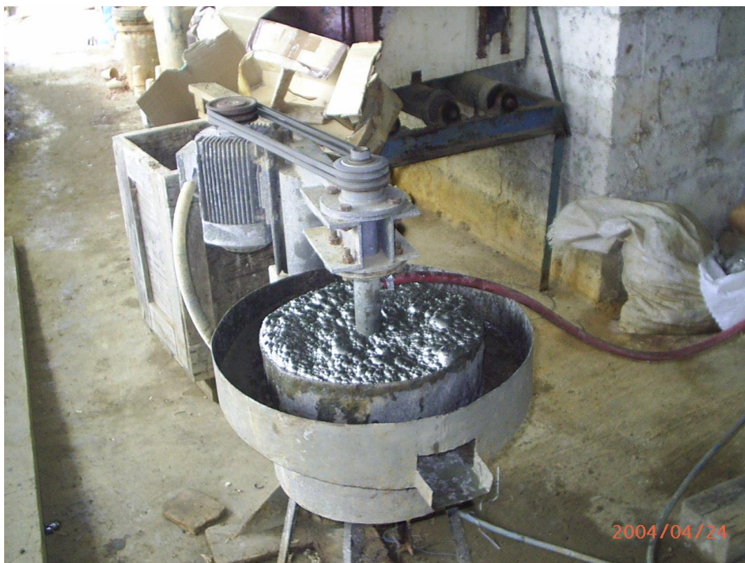
Fotografía N° 17 Inyección de Aire
