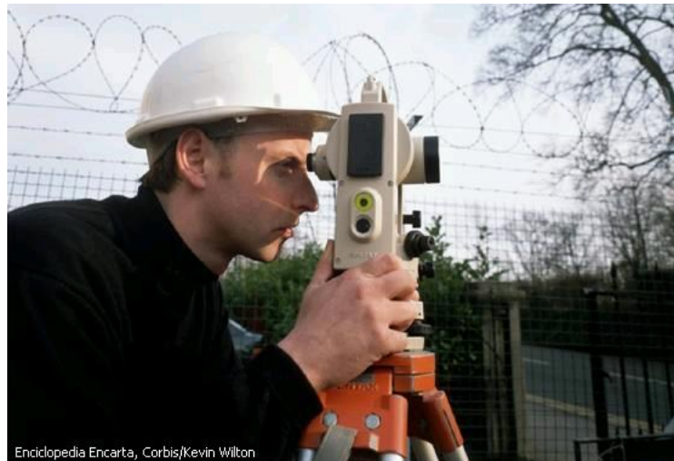
Foto # 5: Teodolito: Instrumento de precisión para obtener datos topográficos.
