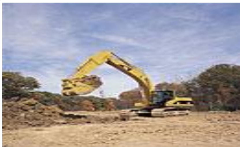
Foto # 19: Retroexcavadora de oruga maquina ideal para el arranque y cargado del mineral.
