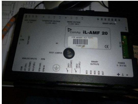
Figura 57. Control Intelilite AMF
