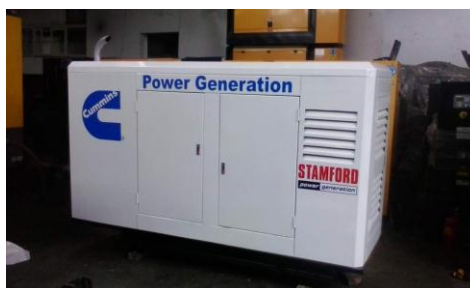
Figura 11. Grupo electrónico encapsulado. (Pintulac, 2015).
