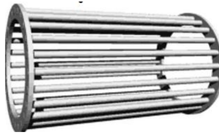
Figura 2. Rotor de Jaula con barras de cobre o Aluminio (Danish Wind Industry Association, 2003).
