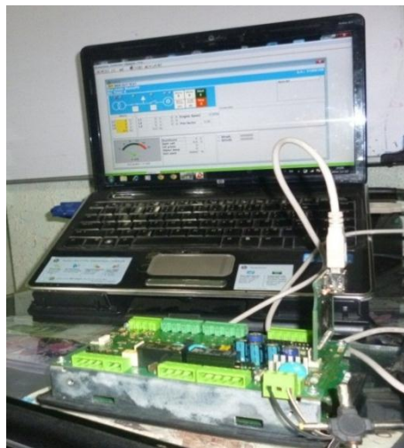
Figura 58. Comunicación con Intelilite AMF
