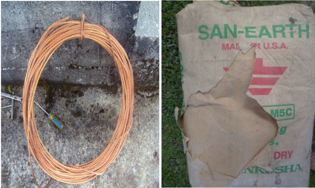
Fig.43: Materiales a utilizarse en la malla de puesta a tierra (cable de cobre #2, cemento conductivo).
