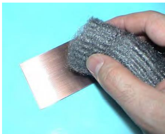
Fig. A.12. Limpieza de los filos de los cortes realizados y la lámina de cobre oxidada
