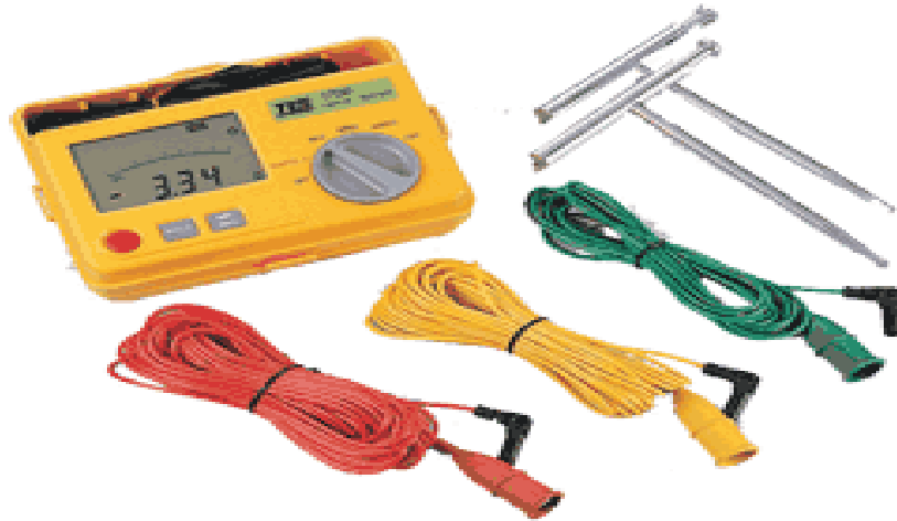
Figura. 20: Teluometro TES-1700 Digital Earth Tester
