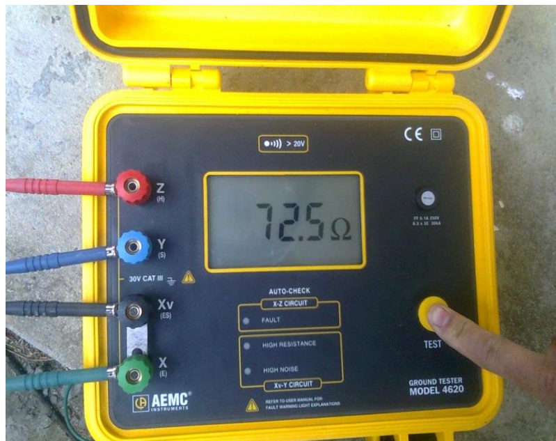
Figura. 30: Dato arrojado por el teluometro AEMC 4620-Resistividad del terreno
