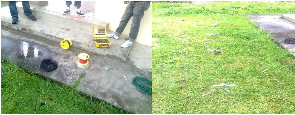
Figura. 29: Medida de resistividad del terreno
