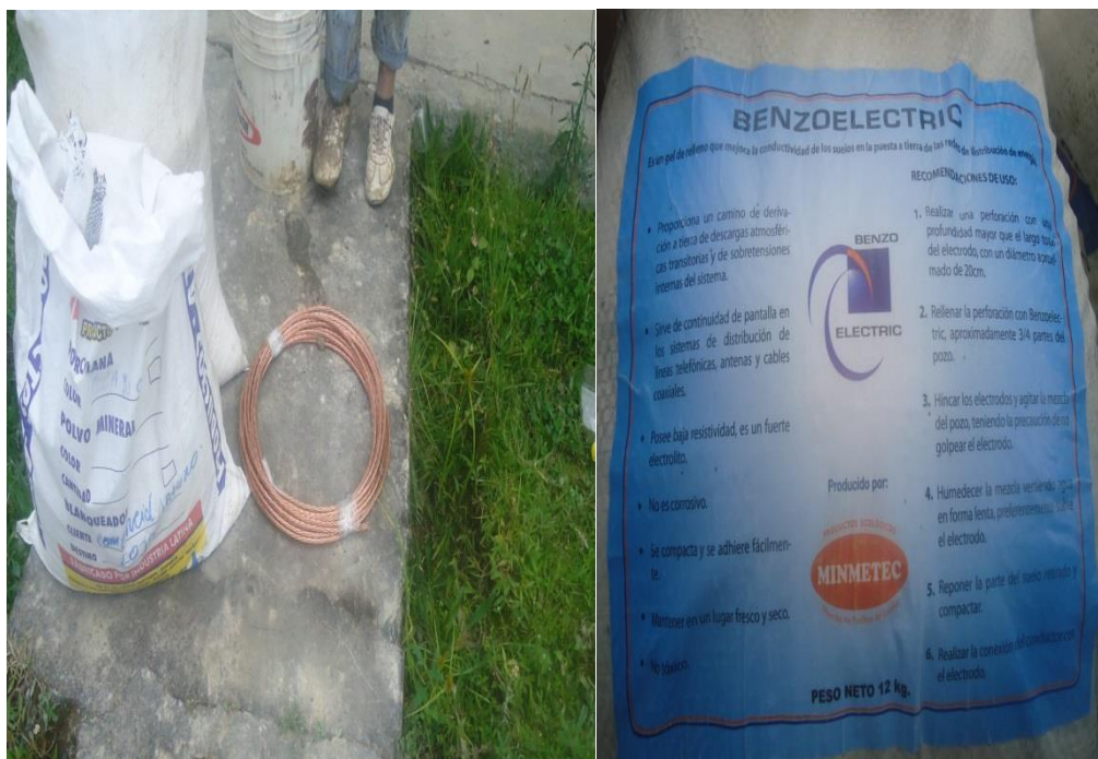
Fig. 34 Cable de cobre y cemento conductivo
