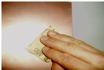
FIGURA III.4A LIMPIEZA DE LA PLACA
