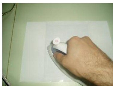
FIGURA III.4C PLANCHADO PARA TRANSFERIR EL DISEÑO DEL PCB
