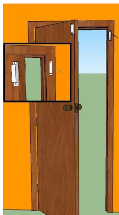
FIGURA 6A NONTAJE DE UNSENSOR MAGNÉTICO, TOMADA DE WWW.ESPERIA.ES/MODULOS
