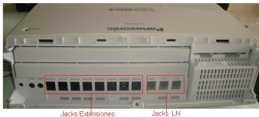
Fig.12 Parte posterior de la central.
