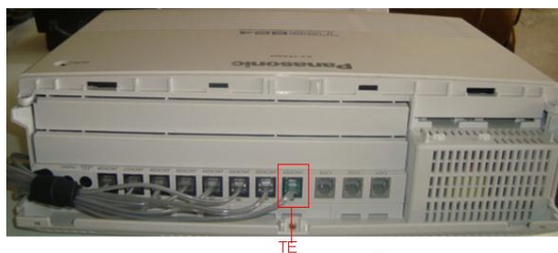
Fig.15 Ubicación del jack del teléfono específico.
