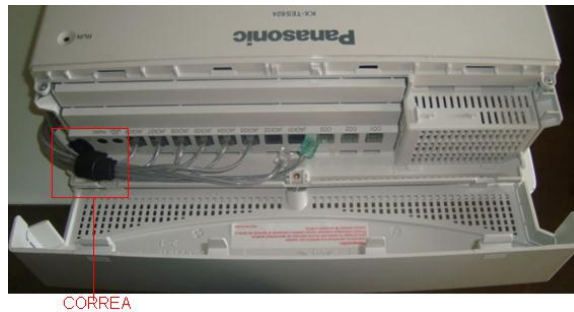
Fig.19 Ubicación de la correa de sujeción de cables.
