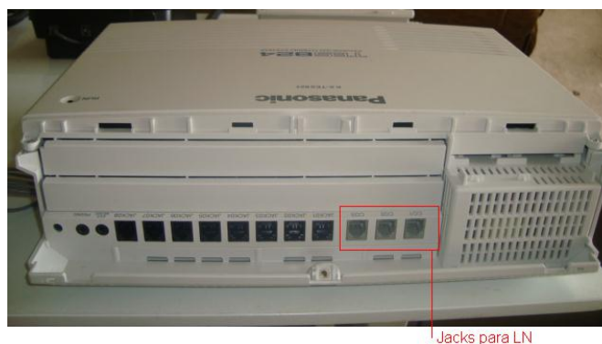
Fig.13 Ubicación de los jacks de Líneas externas.
