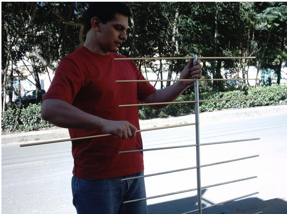
Figura 132. Ensamblado del reflector ubicando las varillas en su respectivo sitio para su fijación
