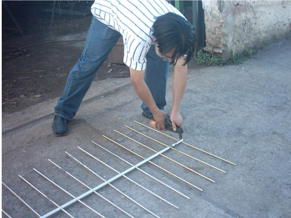
Figura 133. Remachado de los elementos del reflector
