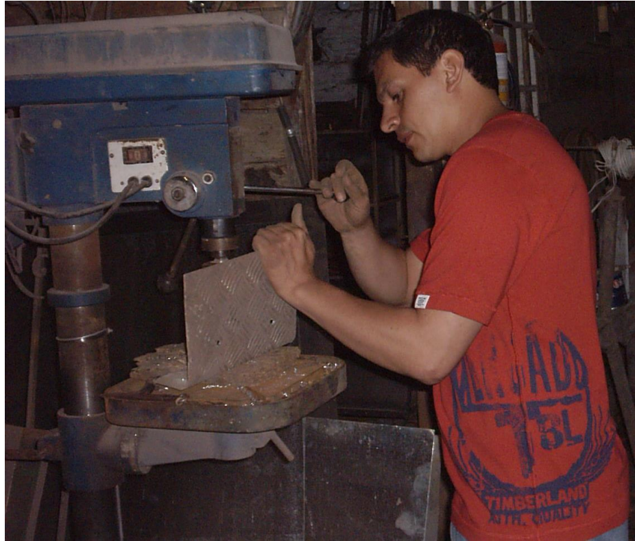
Figura 127 Doblado de las bases y perforación
