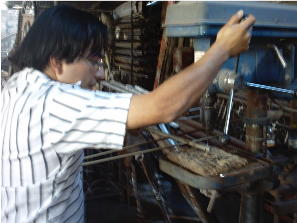
Figura 131. Perforación para la sujeción de las varillas del reflector
