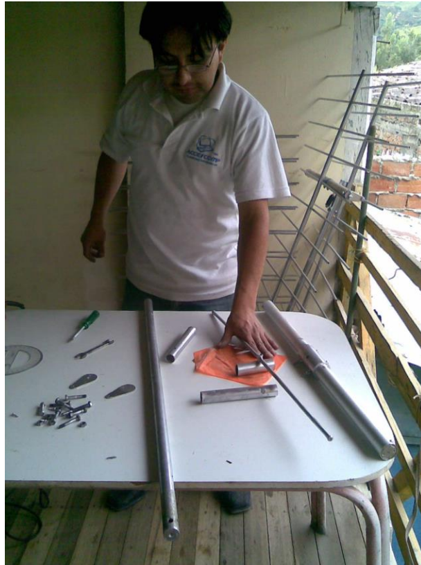
Figura 118. Se ensambla el dipolo de media onda como se puede observar se dispone de todas sus partes
