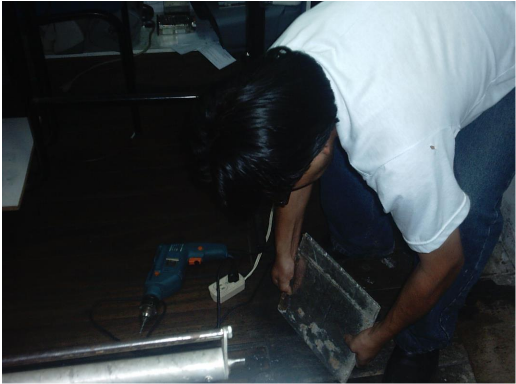
Figura 125. Alineamiento de la base de sujeción para la perforación de orificios
