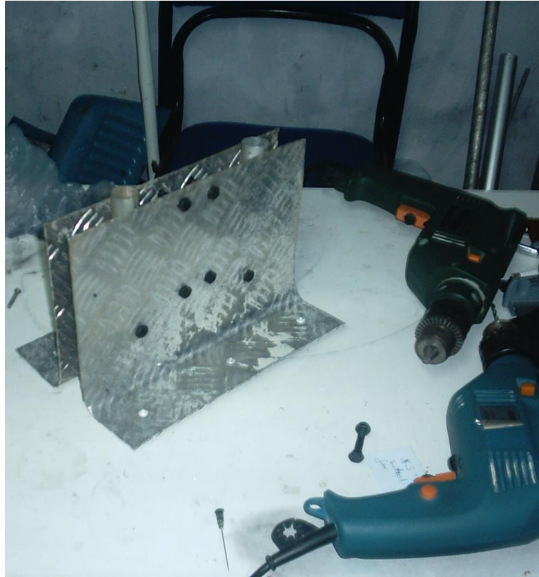
Figura 130 Base de sujeción terminada
