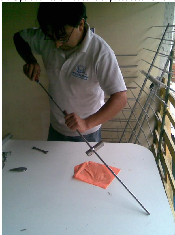
Figura 118. Se ensambla el dipolo de media onda como se puede observar se dispone de todas sus partes
