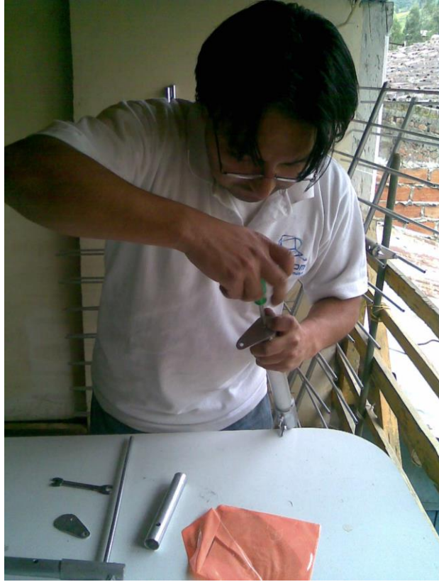
Figura 120. El ensamblaje se lo realizo con sumo cuidado de no alterar la longitud del dipolo
