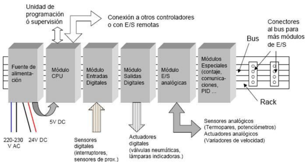
Figura 8. Arquitectura de un PLC
