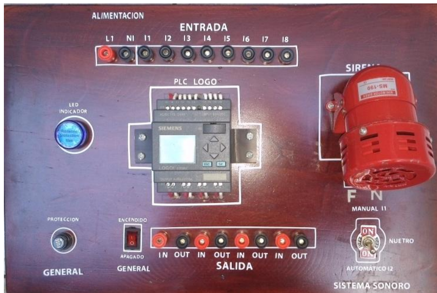
Figura 54. Vista del módulo terminado e implementado.
