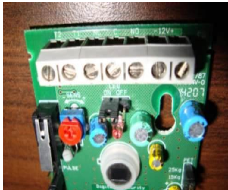
Fig.12 Borneras del sensor de movimiento
