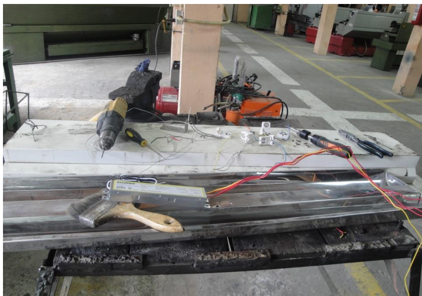
Figura 36. Montaje de transformador y soporte para lámparas
