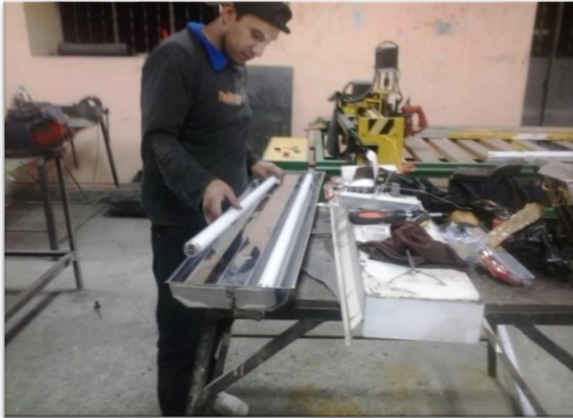
Figura 37. Colocación de tubos fluorescentes
