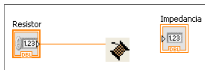
Fig.28. Como conectar dos bloques. Fuente: El Autor.
