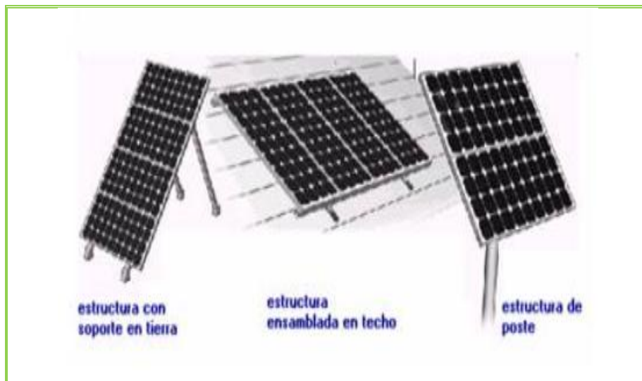
Figura 11. Diversas Estructuras de soporte para paneles fotovoltaicos
