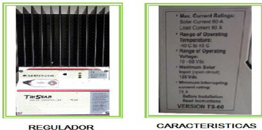
Figura 8. Fotografía del regulador y las características técnicas reales.
