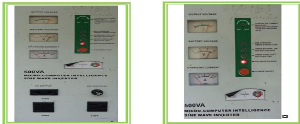
Figura 10. Fotografía del Inversor Fuente. Autor
