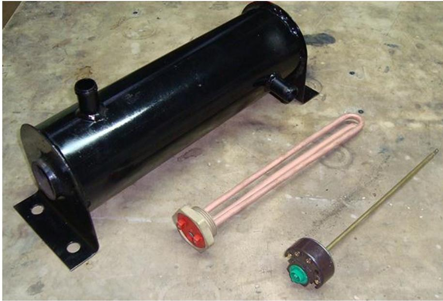
**Figura 6.-** Pre calentador del Block
