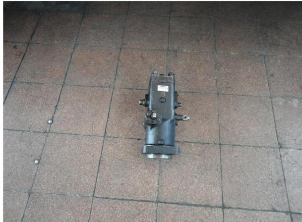
**Figura 102.-** bomba de Inyección del grupo Mirreles
