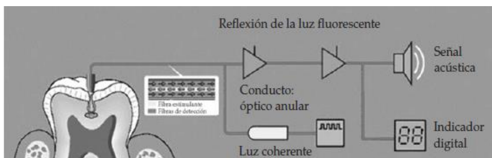
Fig. 20 Esquema de funcionamiento del dispositivo DIAGNOdent
