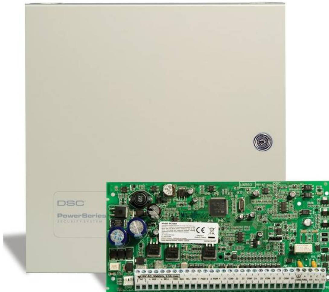
Figura 2. Panel de control con cuatro zonas.
