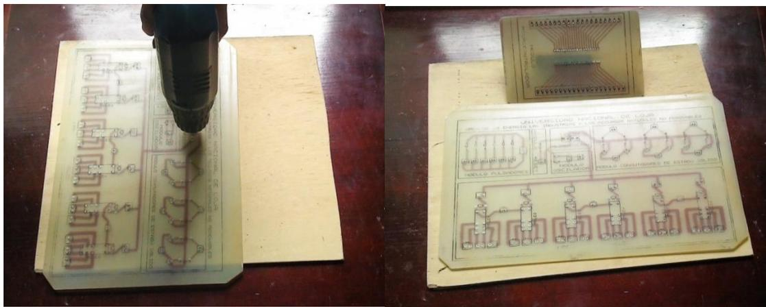
**Figura 46.-** Perforación de las placas perforadas
