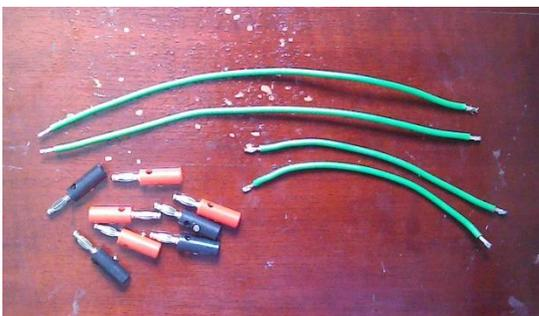
**Figura 61.-** Partes del 'Cable plug'
