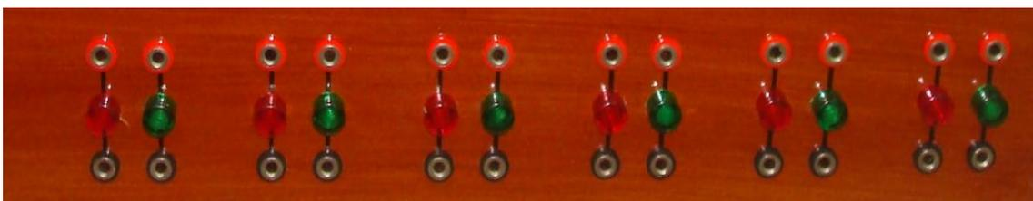
**Figura 76.- Módulo luces piloto**
