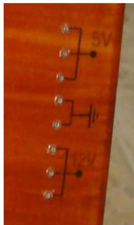
**Figura 79.- Salida de tensión +5V; +12V**
