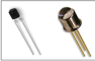
**Figura 5.- Fototransistores**
